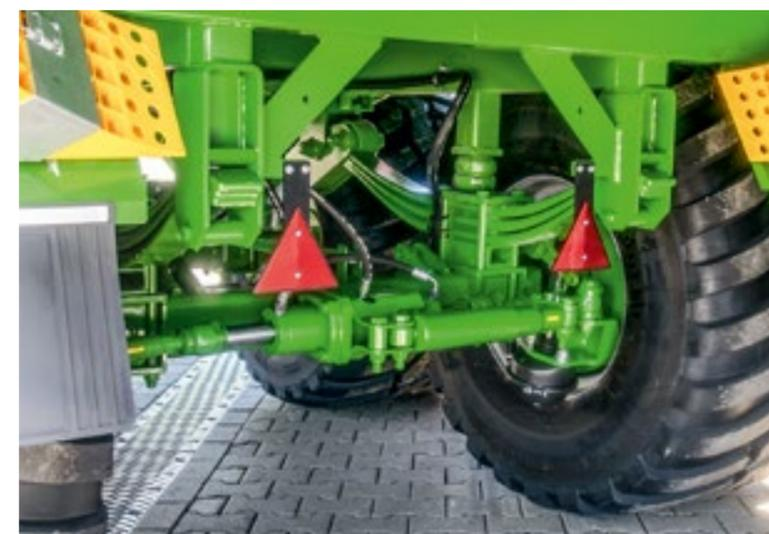
Für noch höheren Fahrkomfort, deutlich geringeren Reifenverschleiß und mehr Bodenschonung ist eine **Nachlauf-Lenkung** optional erhältlich.
