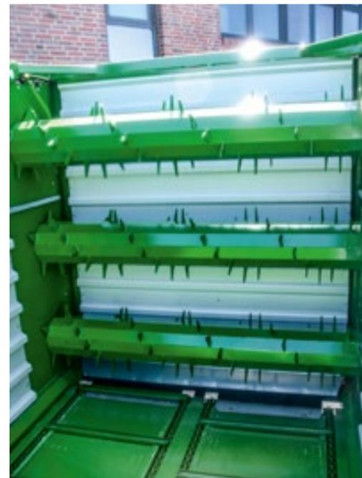
Dosieraggregat der S-Modelle mit serienmäßig 3 Dosierwalzen (**REPEX 29 S / REPEX 31 S / REPEX 32 S / REPEX 34 S**).
