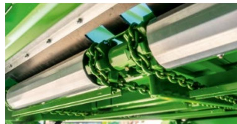
Die vier **Rundstahlketten** (je 11 x 31 mm, 15 t/Kette) sind tief in große Kettennüsse eingebettet (wenig Verschleiß), die Ketten paarweise gestreckt. Umlenkrollen, vorne und hinten mit Räumern, sorgen für eine sichere Führung der Transportbodenketten.
