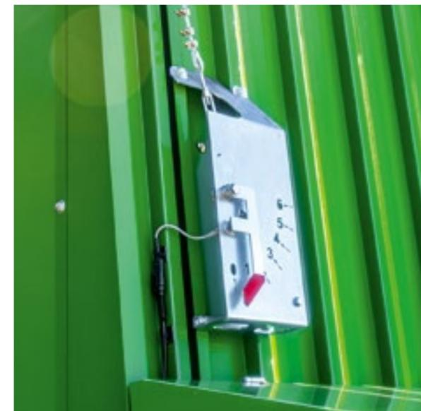
Die Abladeweite kann durch die Stellung der Heckklappe reguliert werden. Die Position der Heckklappe wird auf der serienmäßigen **Heckklappenanzeige** an der Stirnwand dargestellt.
