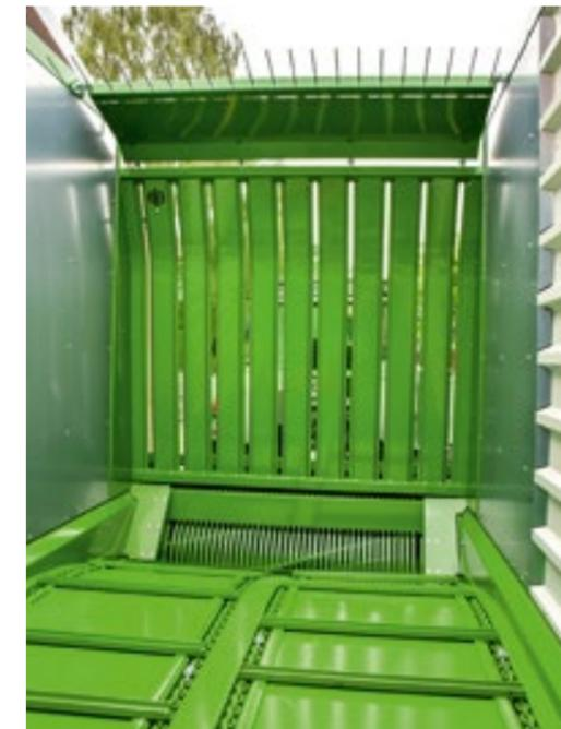
Der Laderaum wird durch den breiten **Förderkanal** optimal befüllt. Der nach vorne um 200 mm abgesenkte **Stahl-Transportboden** reduziert die Förderkanalhöhe und bedingt einen deutlich geringeren Kraftaufwand für den Rotorantrieb, schont das Futter und erhöht die Ladeleistung. Die im vorderen Bereich glatten Innenseiten und Seitenwände reduzieren Reibungskräfte beim Befüllvorgang.
