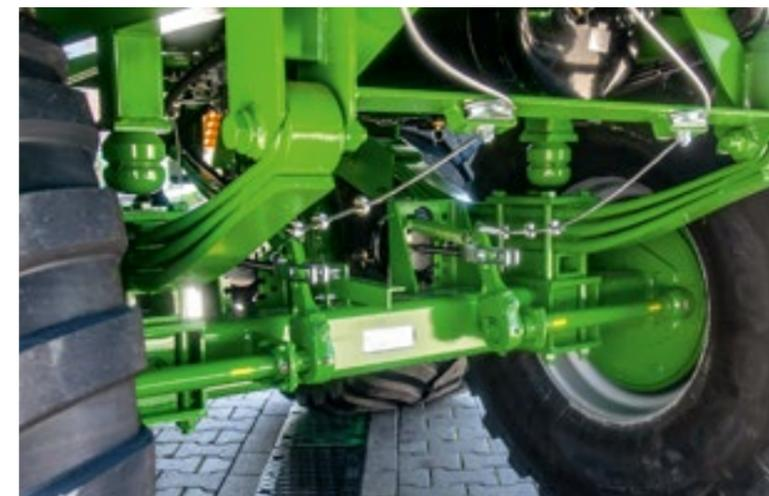
Alle **REPEX**-Modelle sind serienmäßig mit einem gefederten Tandem-Achsaggregat mit Pendelausgleich ausgestattet.
