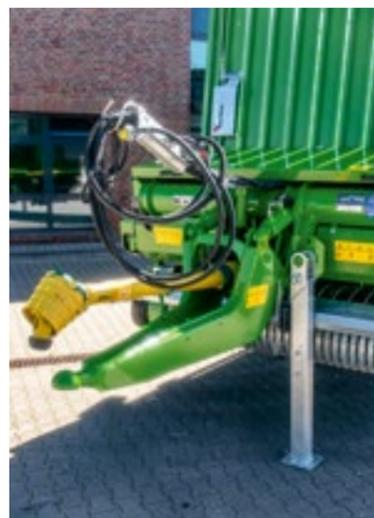
Bei den **REPEX**-Modellen 32 S / 33 K / 34 S / 35 K ist die Untenanhangung und Kugelkopfkupplung K 80 serienmäßig.
