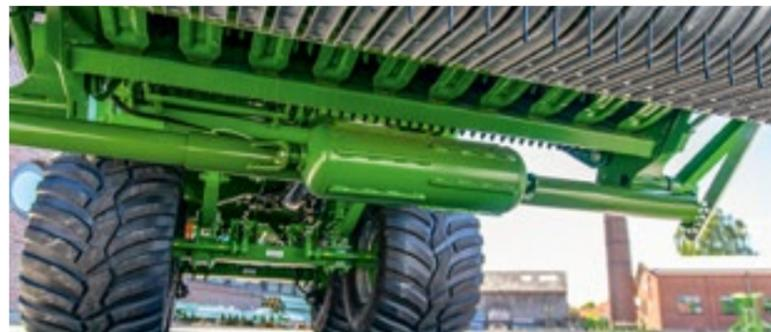
Für eine optimale Boden Anpassung ist die **Tastwalze** für die Pick-up optional erhältlich. Die – ebenfalls optional erhältliche – **Pick-up-Entlastung** sorgt dafür, dass die Pick-up stets mit konstantem Auflagedruck sanft über den Boden rollt und das Futter sauber aufnimmt.
