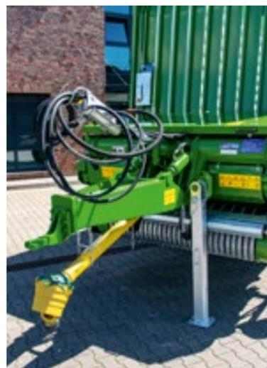
Die **REPEX**-Modelle 29 S / 30 K / 31 S / 32 K sind serienmäßig mit Obenanhangung und Zugöse 40 mm ausgestattet. Eine Untenanhangung ist optional erhältlich
