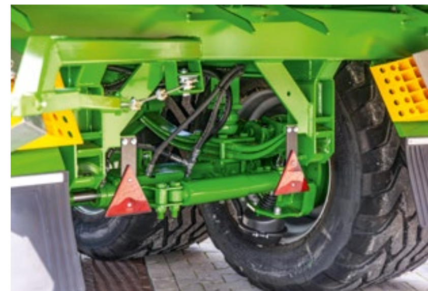
Für noch höheren Fahrkomfort, deutlich geringeren Reifenverschleiß und mehr Bodenschonung ist eine Nachlauf-Lenkung optional erhältlich.
