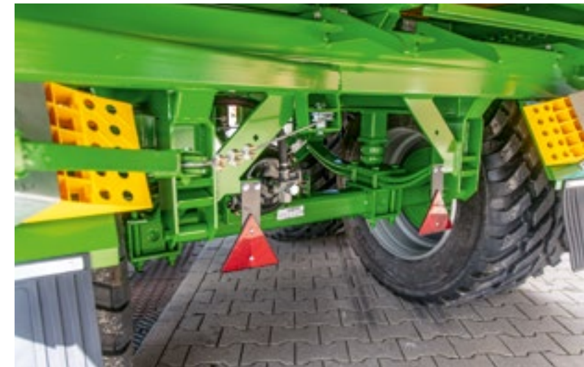
Die Einstellung der Deichsel und des Messerbalkens erfolgt bequem an der linken Fahrzeugseite.
