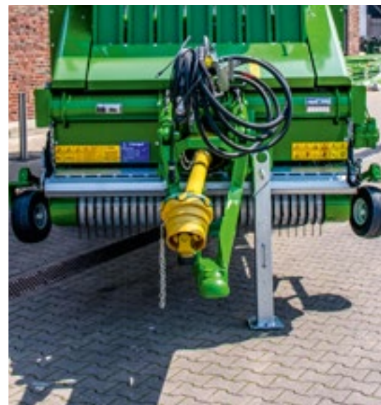
Die kompakte Bauweise der schmalen Deichsel sorgt für eine hohe Wendigkeit. Der Stützfuß ist schwenkbar und am Rahmen befestigt.
