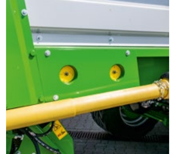
Die Einstellung der Deichsel und des Messerbalkens erfolgt bequem an der linken Fahrzeugseite.
