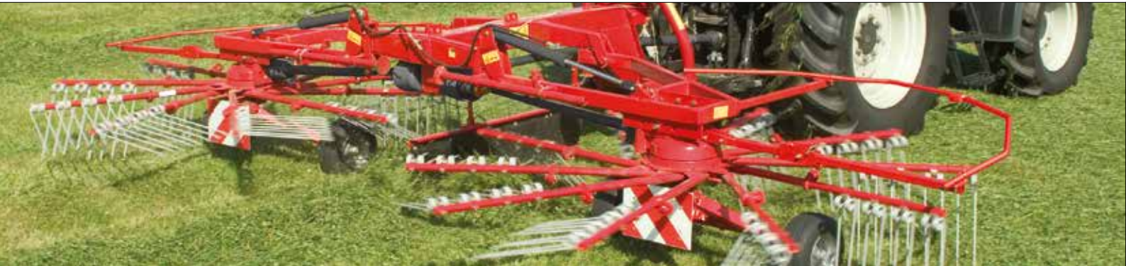
R 655 DS ein Mittelschwader mit 3-Punkt Anbau
