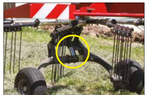
R+ 1410 SB mit Bogenlenkung für enge Kurven. Das beste Ergebnis wird mit zwei überlappenden Kreiseln erzielt.
