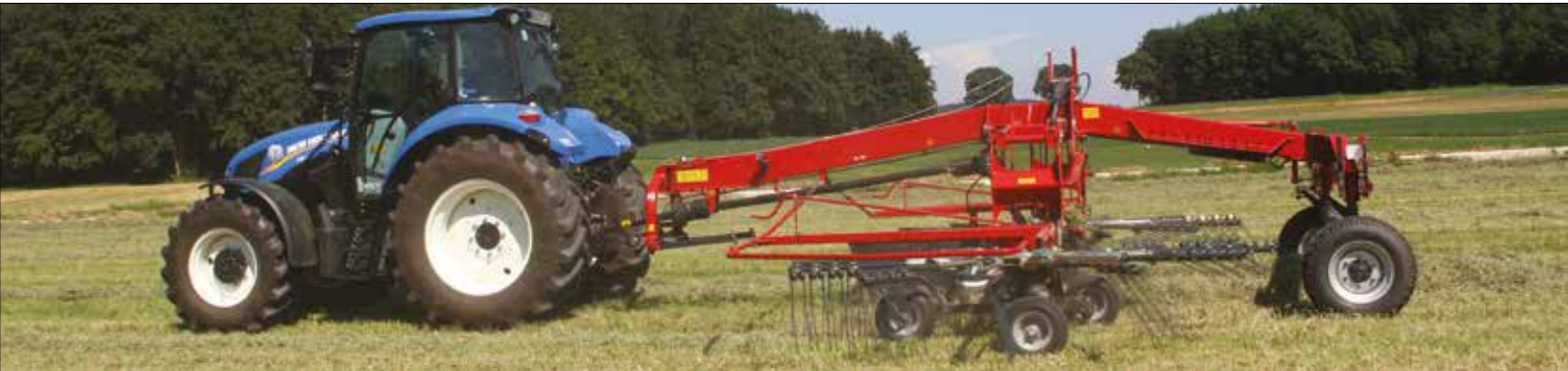
R+760 ein gezogener Mittelschwader (Arbeitsbreite 6.80-7.60 m).
