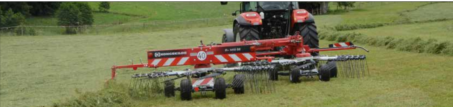
R+ 1410 SB - Seitenschwader mit Multi Link Rahmen
