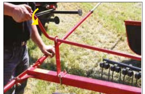
Mit der Verstellkurbel kann die Arbeitstiefe und der Winkel des Kreisels eingestellt werden.
