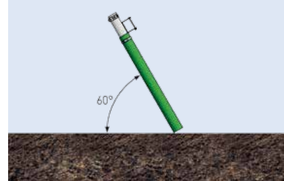
Die korrekte Applikation eines Schleppschlauchgestänges: bodennah!
